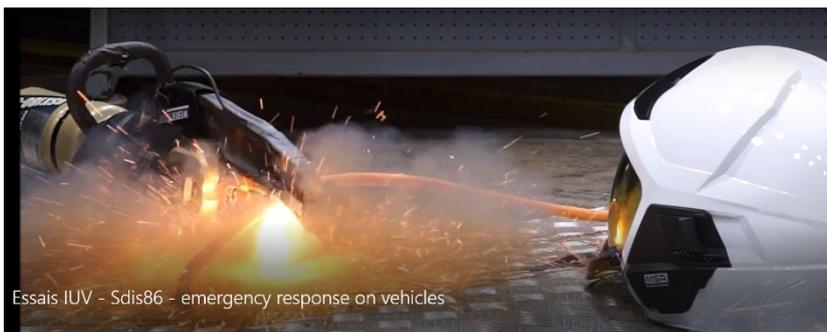
Abbildung 13: Lichtbogen beim Trennen einer 48 Volt Leitung (Sapeurs-pompiers de la Vienne, ÖBFV Film Gefahrenlehre)
