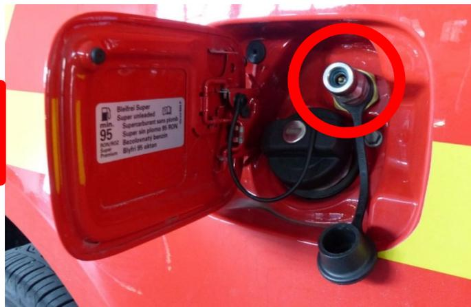
Abbildung 25: Zusätzlicher Tankstutzen für Betankung von Erdgas (SFS Würzburg Winterschulung „Alternative Antriebe“)
