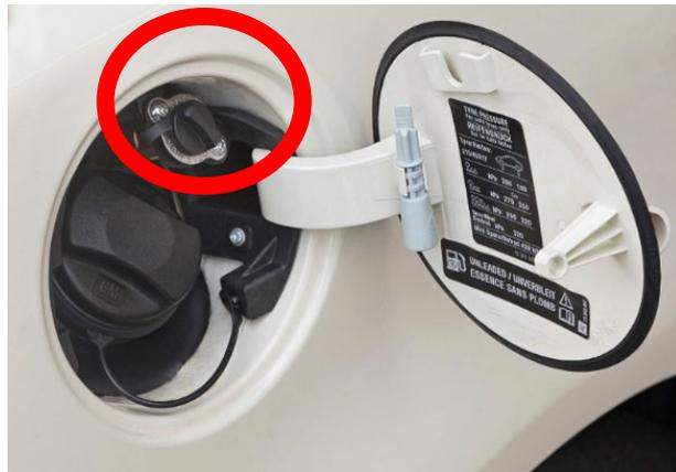
Abbildung 39: Zusätzlicher Tankstutzen für die Betankung von Erdgas (Volkswagen AG)
