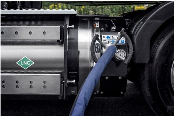
Abbildung 35: LNG Betankung (Volvo)
