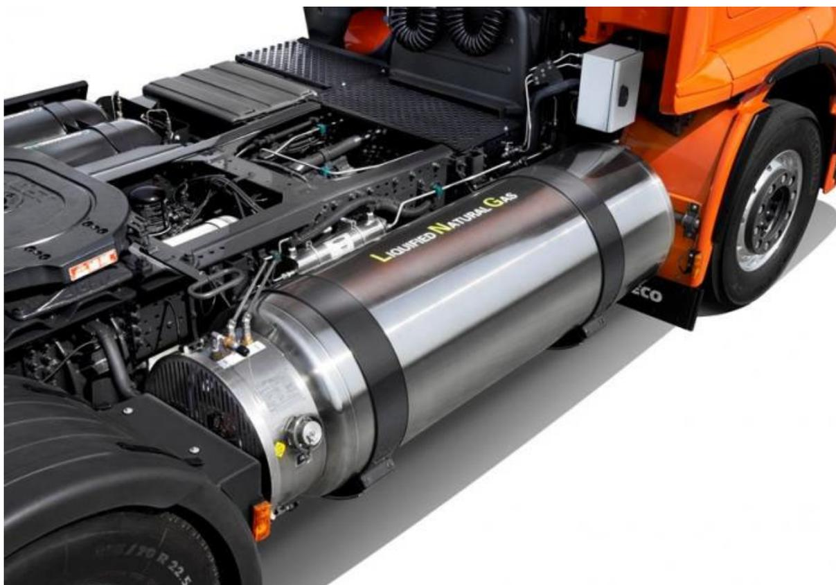
Abbildung 31: LNG - Tank (isoliert) (Iveco)
