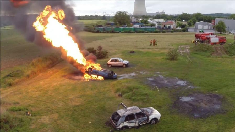
Abbildung 54: Austritt von Flüssiggas in Flüssigphase (Sapeurs-pompiers de la Vienne)
