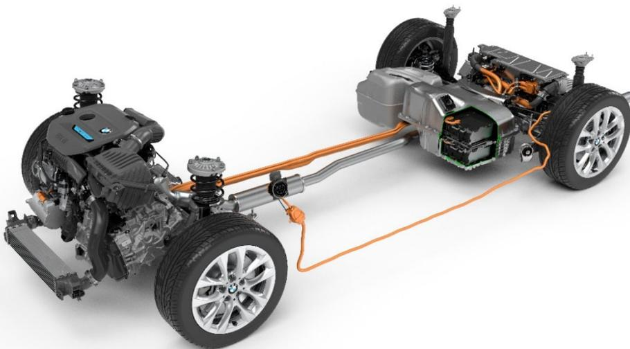
Abbildung 1: Antriebssystem Hybridfahrzeug (BMW AG)
