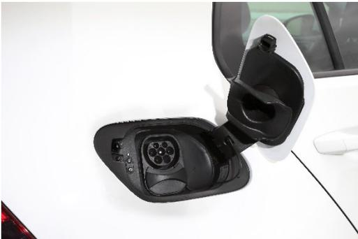
Abbildung 8: Lademöglichkeit hinter Tankdeckel (Volkswagen AG)
