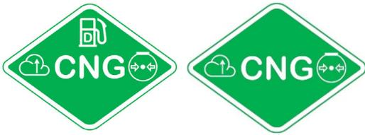
Abbildung 23: Piktogramme mit Kennzeichnung von „CNG+DIESEL“ (links) und „CNG“ (rechts) nach ISO 17840
