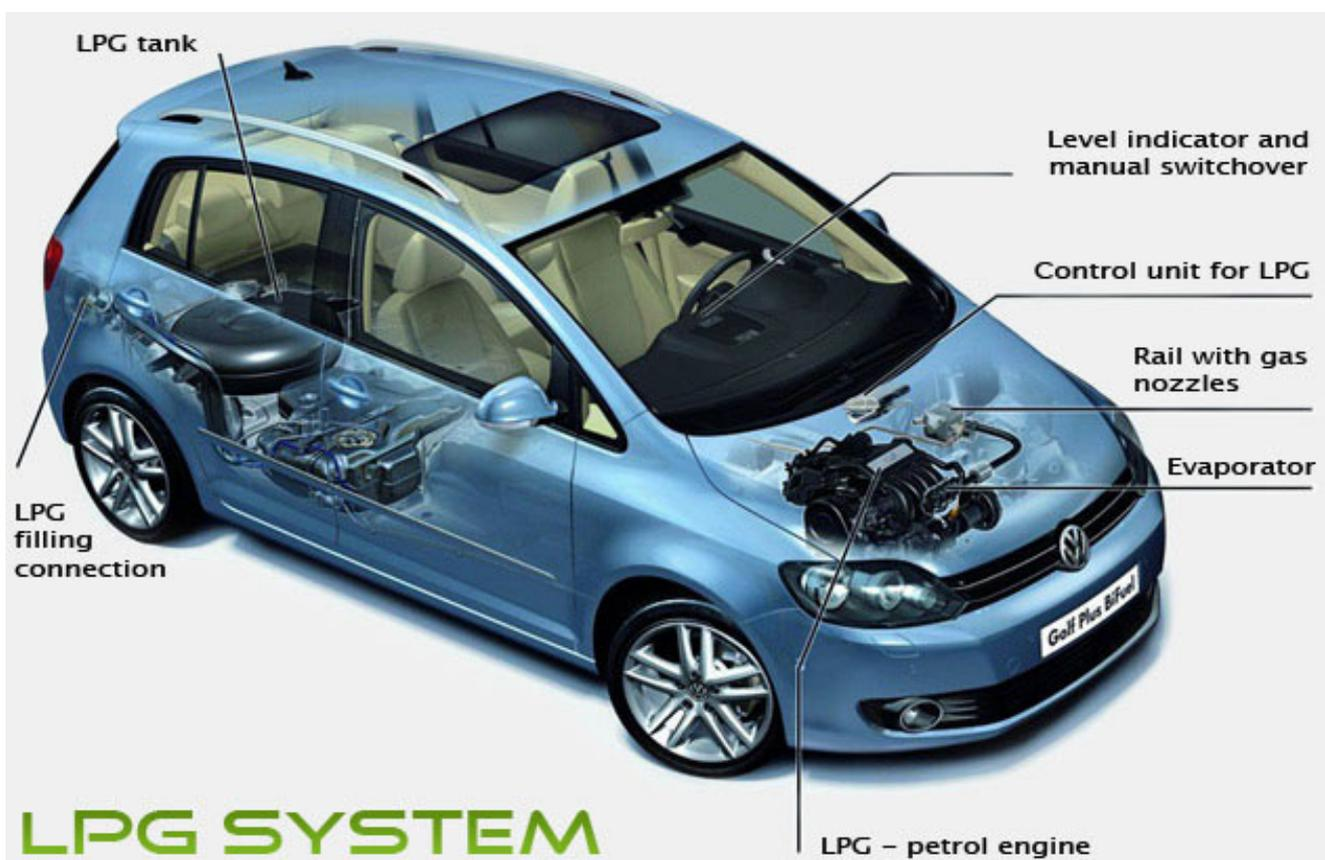
Abbildung 36: Antriebssystem LPG-Fahrzeug (Volkswagen AG)
