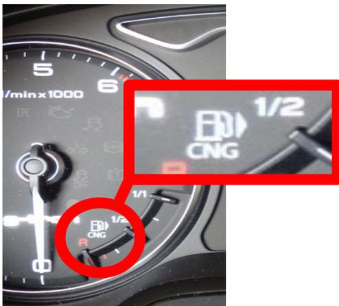
Abbildung 24: Anzeige CNG in der Instrumententafel (Audi AG)
