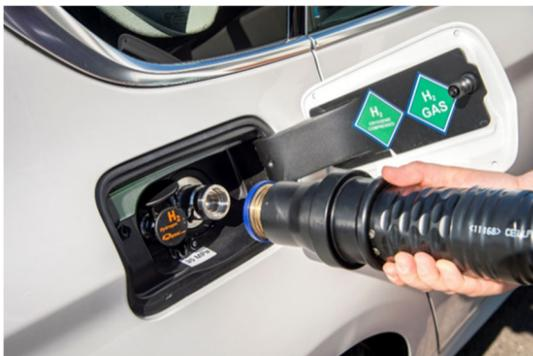
Abbildung 18: Betankungssystem Wasserstoff (Audi AG)
