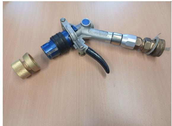
Abbildung 50: LPG Zapfhahn mit
