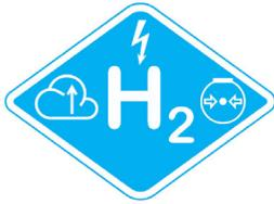
Abbildung 16: Piktogramm mit Kennzeichnung eines „Wasserstoffantriebs mit Brennstoffzelle“ nach ISO 17840
