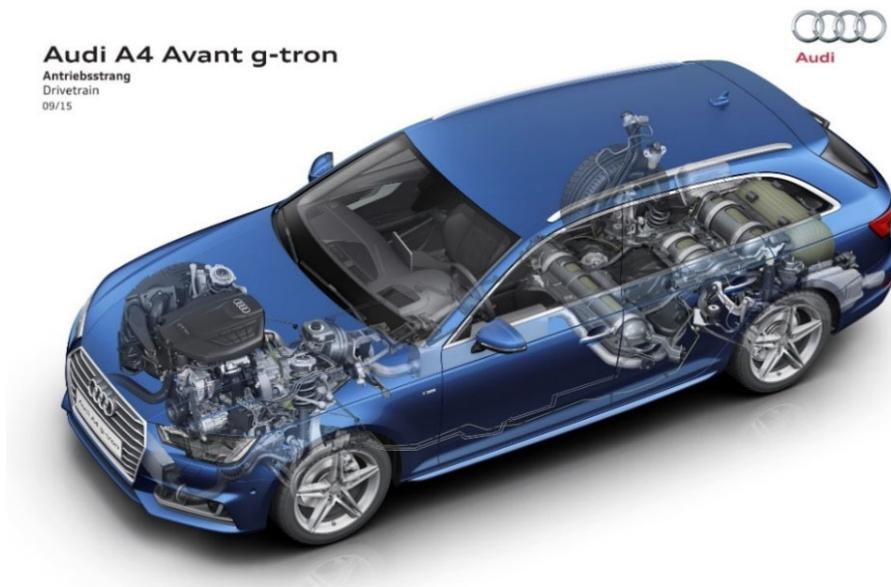
Abbildung 21: Antriebssystem Erdgasfahrzeug (Audi AG)
