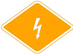
Abbildung 7: Piktogramm mit Kennzeichnung von Elektroantrieben nach ISO 17840
