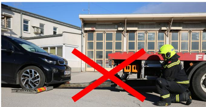
Abbildung 58: Kein Schleppen von Hybrid- und Elektrofahrzeugen (Wolfgang Niederauer, ÖBFV)
