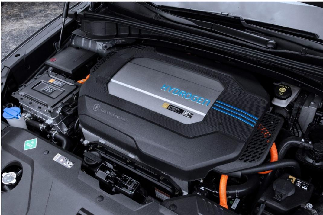
Abbildung 19: Motorraum eines Fahrzeuges mit Brennstoffzelle (Hyundai)
