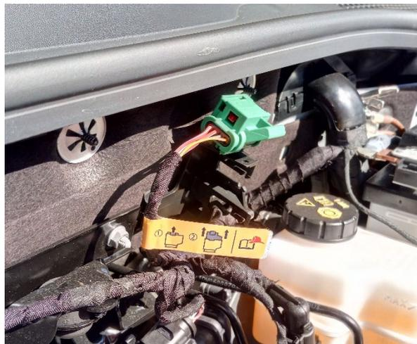
Abbildung 11: HV Trennstelle für Einsatzkräfte (Wolfgang Niederauer, ÖBFV)
