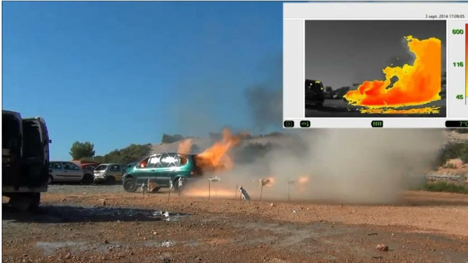
Abbildung 20: Ausgelöste Sicherheitseinrichtung bei einem brennenden Wasserstofffahrzeug (Sapeurs-pompiers de la Vienne)
